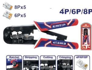
Crimpadora de Enchufe Modular Utilizada para engarzar terminales de línea de red y línea telefónica Rango de engarzado: 4P, 6P, 8P Longitud: 8" Diseño de trinquete que ahorra trabajo Tres funciones: Engarzado, Desforrado, Corte Diseño único de mango de PVC Con 10 conectores de paso: 8Px5pcs; 6Px5pcs Empaque en tarjeta blister
